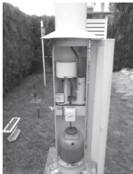
Slika 2. Helmanov pluviograf (registrijuću kišomjer)
