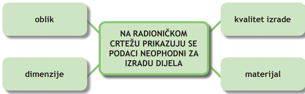
Svaka greška na radioničkom crtežu preslikava se na dio koji se izrađuje. Pogrešno izrađeni djelovi ne mogu se ugraditi u zamišljeni proizvod. Zato radionički crteži moraju biti precizni, razumljivi, pregledni i urađeni prema standardu (standard je propis o mjerama i kvalitetu pojedinog proizvoda). Kada se na osnovu radioničkih crteža naprave svi djelovi, vrši se sklanjanje (sastavljanje) zamišljenog proizvoda na osnovu **montažnog crteža** (sl. 1.7).
