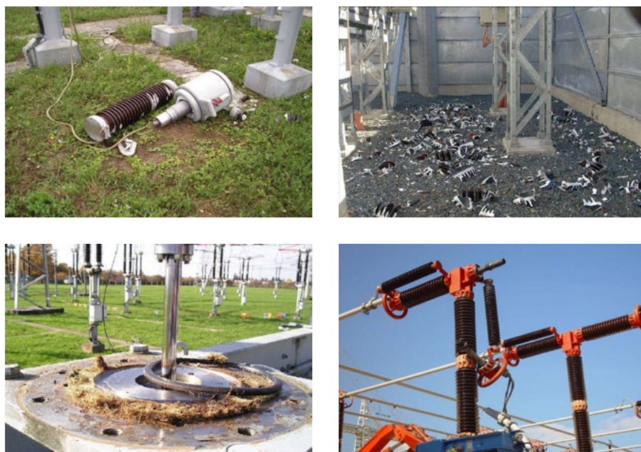
Slika 4.1. Primjeri velikog kvara na različitim elementima VNRP
