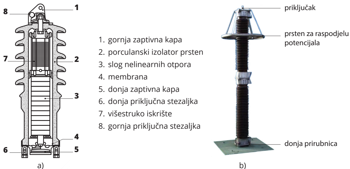
Slika 1.49. Silicijum-karbidni odvodnik prenapona: a) skica, b) slika
