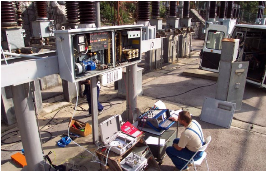
Slika 4.18. Primjeri ispitivanja VN opreme u različitim uslovima na terenu
