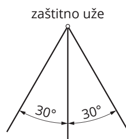
Slika 3.18. Zaštitna zona voda sa jednim zaštitnim užetom
