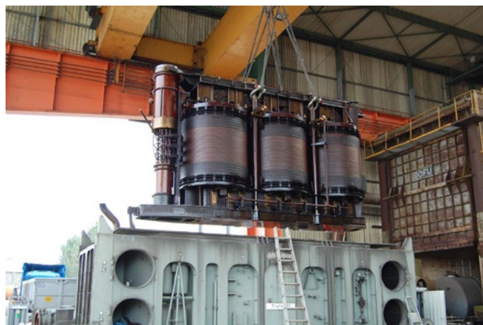
Slika 5.5. Fabričko montiranje jezgra većeg energetskog transformatora
