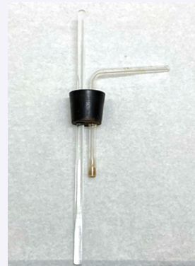
Slika 3.55. Priprema staklenih cijevi za balon
