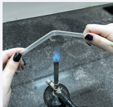
Slika 3.51. Savijanje staklenih cijevi i štapića
