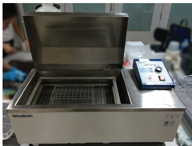
Slika 2.7. Vodeno kupatilo – reakcioni sud se smješta iznad vode
