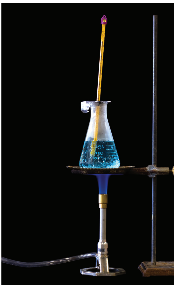
Slika 2.5. Zagrijavanje sa azbestnom mrežom
