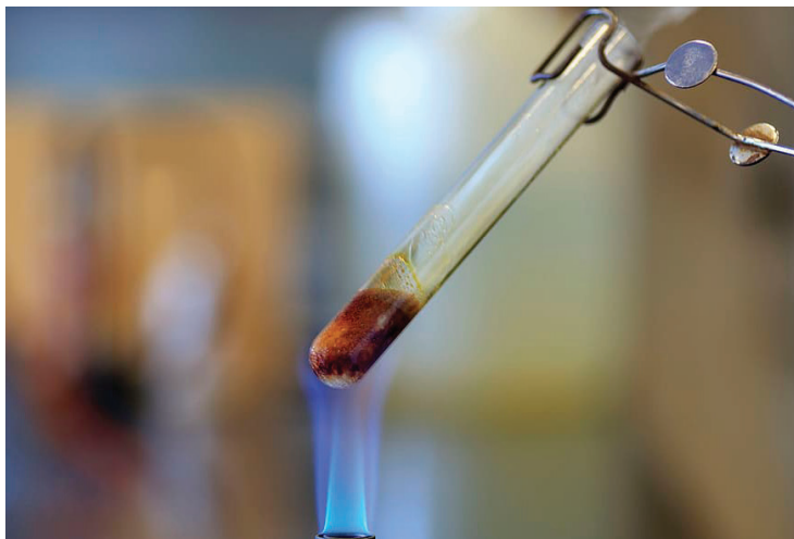
Slika 1.12. Pravilno držanje epruvete pri zagrijavanju
