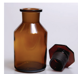
Slika 2.23. Reagens-boca s tamnim staklom
