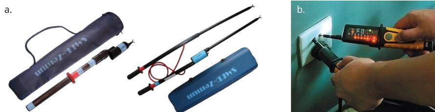
Slika 3.24. Indikatori visokog (a) i niskog (b) napona
