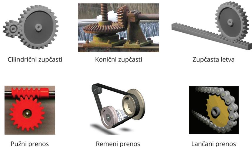
Slika 5.39. Razni tipovi mehaničkih prenosnika energije
