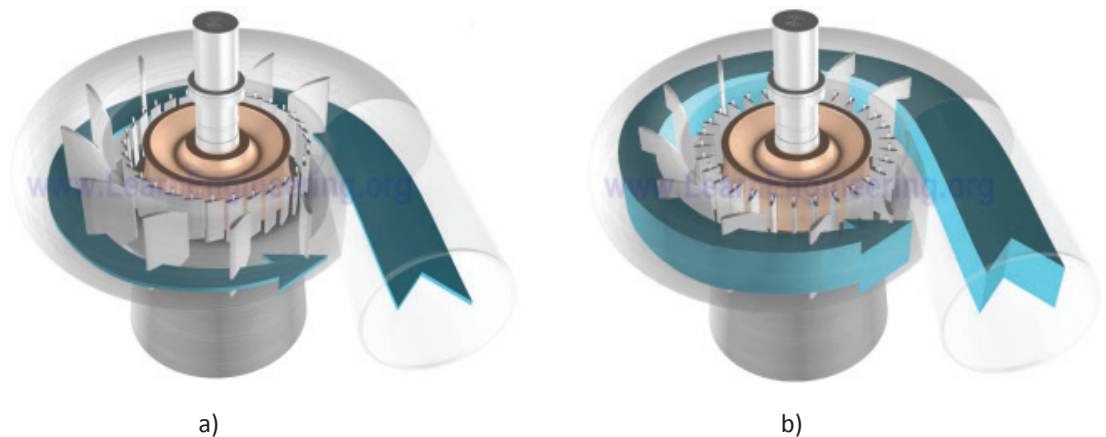
Slika 2.31. Fransisova turbina u zatvorenom (a) i otvorenom (b) položaju
