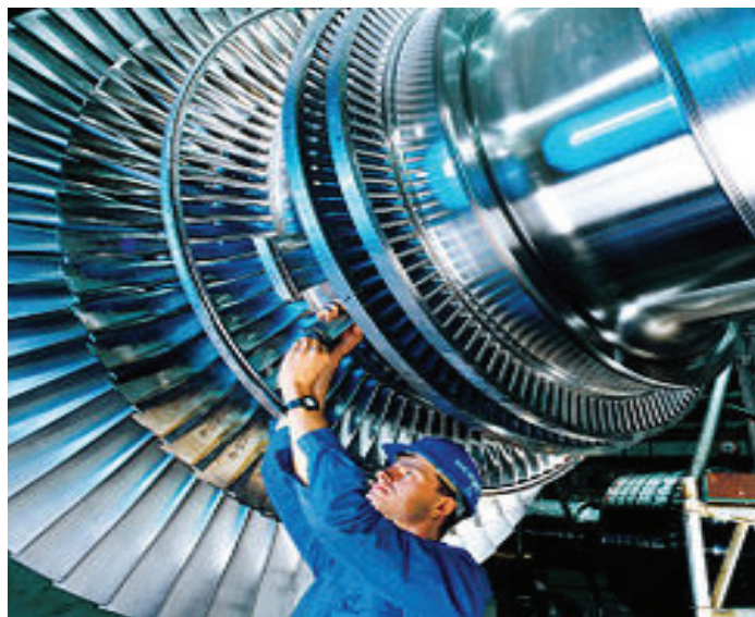
Slika 2.83. Rotor moderne parne turbine
