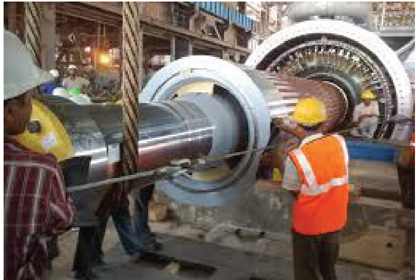
Slika 2.87. Proces kompletiranja turbogeneratora
