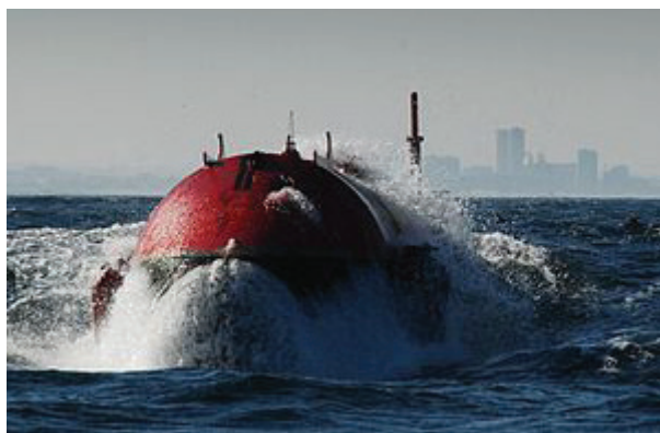
Slika 3.7. Plutajući dio elektrane na talase Pelamis
