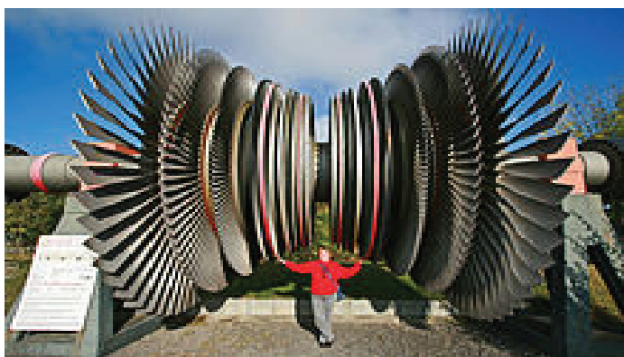
Slika 2.85. Dvostrujni rotor parne turbine
