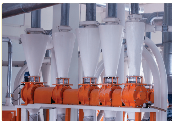
Slika 1.2. Tehnološka linija za proizvodnju integralnog brašna
