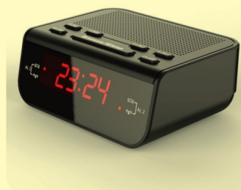
Slika 7.33. Prikazivanje vremena na displeju pomoću sedmosegmentnih indikatora
