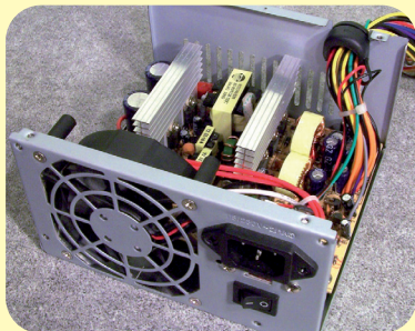
Slika 4.15. Računarsko napajanje (na izlazu daje više nivoa jednosmjernog napona)
