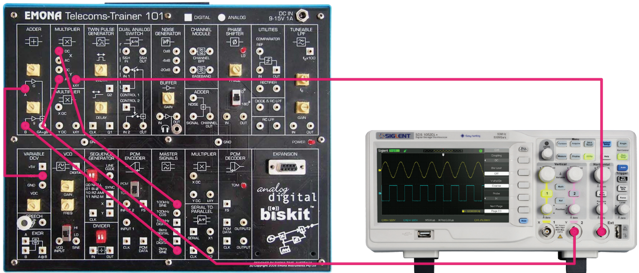
Slika 6.27. Povezivanje opreme za generisanje KAM signala
