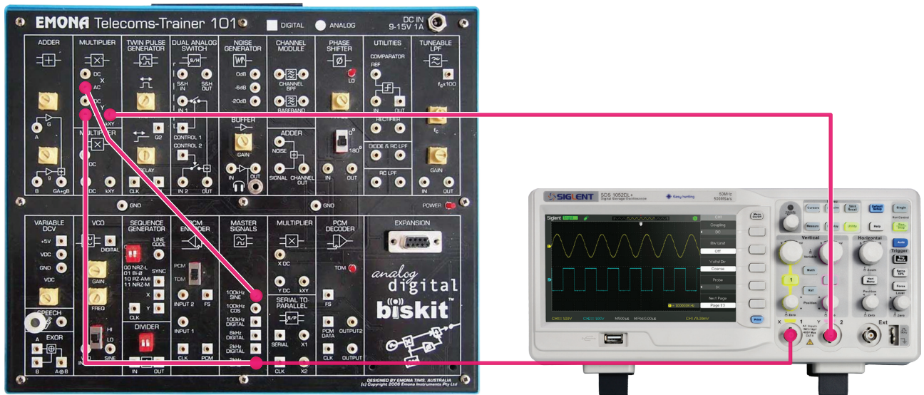
Slika 6.25. Povezivanje opreme za generisanje AM signala
