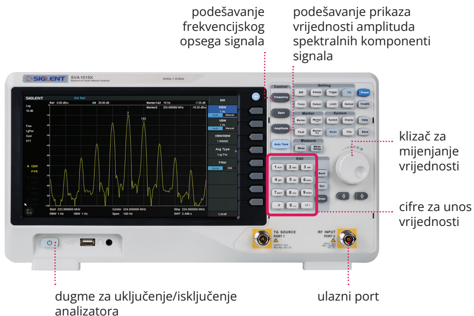
Slika 6.17. Glavne komande na analizatoru spektra
