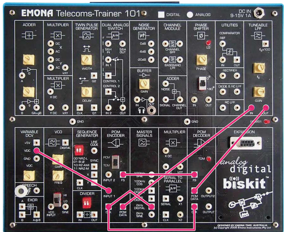
Slika 6.33. Šema povezivanja uređaja ETT-101 za vježbu br. 5
