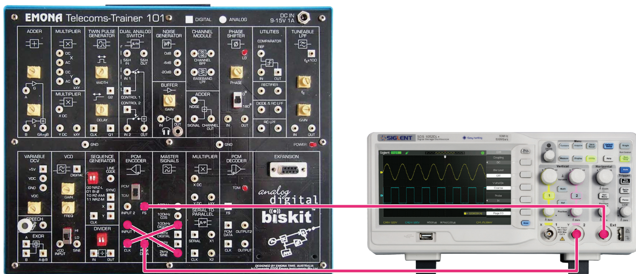
Slika 6.31. Šema povezivanja ETT i osciloskopa
