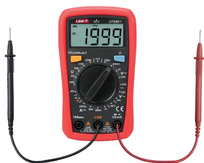
Slika L.4 Povezivanje mjernih kablova sa priključcima multimetra za mjerenje napona i malih struja
