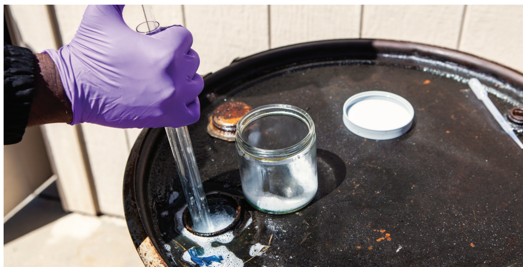
Slika 1.31. Postupak uzorkovanja agresivne tečnosti pomoću sonde
