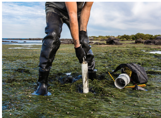
Slika 1.36. Neporemećeno uzorkovanje sedimenta
