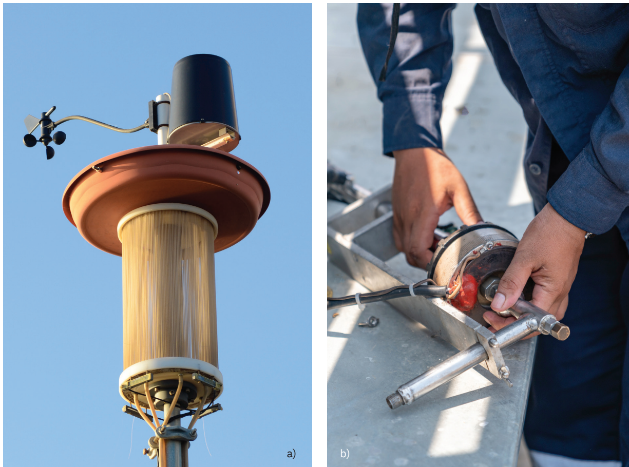
Slika 3.8. Filter za uzorkovanje vazduha (a), priprema filtera nakon uzorkovanja (b)
