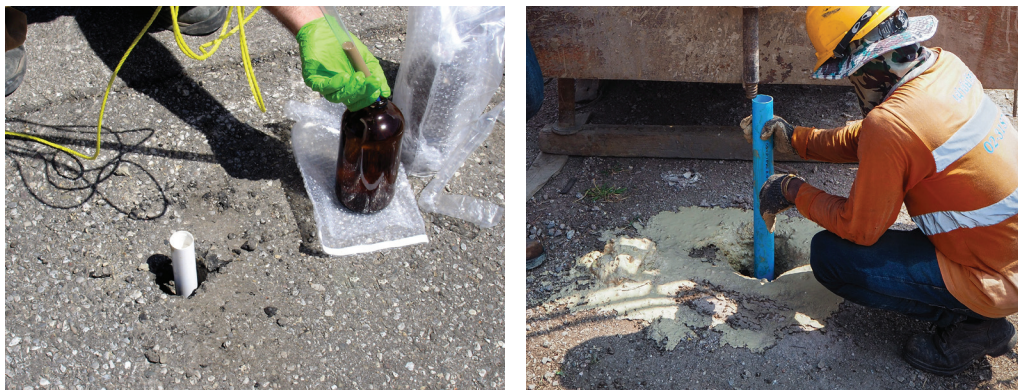
Slika 1.4. Posuđe za uzimanje uzoraka podzemnih voda pomoću piiezometra
